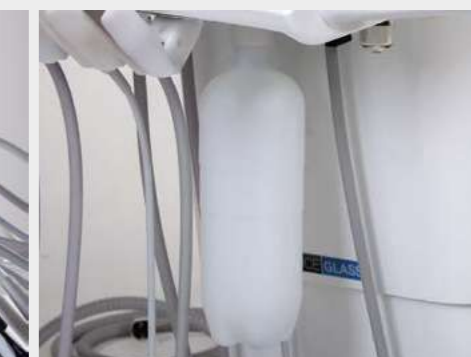
SISTEMA DE SUMINISTRO DE AGUA INDEPENDIENTE POR BOTELLA SEPARADA DENTRO DE LA UNIDAD + BYPASS
